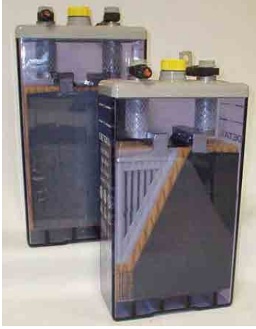
شكل ٢٦: شكل نموذجي للألواح الأسطوانية الشكل opzs أ- شرائح الشبكة OGI ب- بطارية الرصاص
